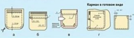
Накладной карман с закругленными краями без отделочной строчки по верхнему краю
